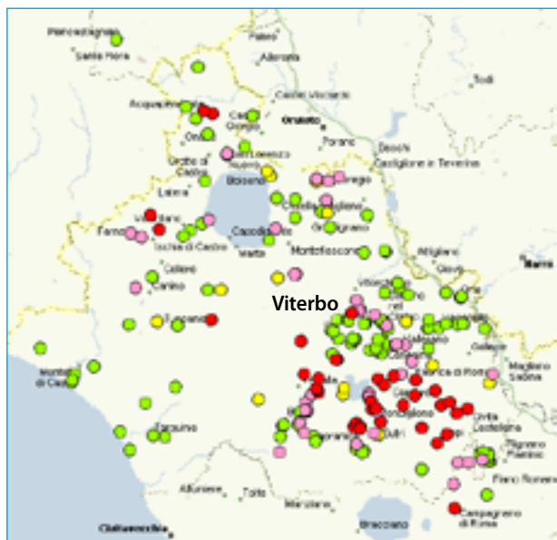
Figura 2 - Distribuzione della concentrazione di arsenico negli acquiferi dell'area Viterbese impiegati per la captazione di acqua da destinare al consumo umano. In verde, acquiferi con livelli fino a 9 µg/L; in giallo, acquiferi con livelli fino a 11 µg/L; in rosa, acquiferi con livelli fino a 20 µg/L; in rosso, acquiferi con livelli oltre 20 µg/L
